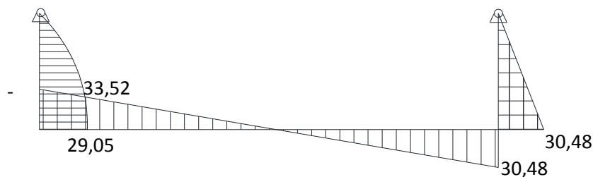
9.34 сурет—Стержень жүйесіндегі эпюра кезеңі [кН·м] (мысалы 9)
